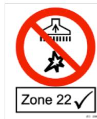
Denne standarden gjelder sikkerheten for støvsugere med elektriske motorer, inkludert støvutskillere og ryggbårne støvsugere, som brukes til våtsuging, tørrsuging eller våt- og tørrsuging, som er egnet for kommersiell bruk innendørs og utendørs, med og uten tilbehør for oppsamling av brennbart støv i en atmosfære (sone 22) som betegnes som ekspløsiv.
