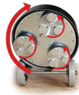
Figur 41 Illustrerar sliphuvudernas rotation i förhållande till växelhuset.
