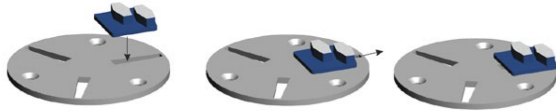
Figur 44 Montering av verktyg på Scan-On-fästskivor
