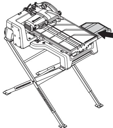
Sivupöytä on säädettävä siten, että se on samalla tasolla kuljetustelineen kanssa. Säädä ruuveilla.
