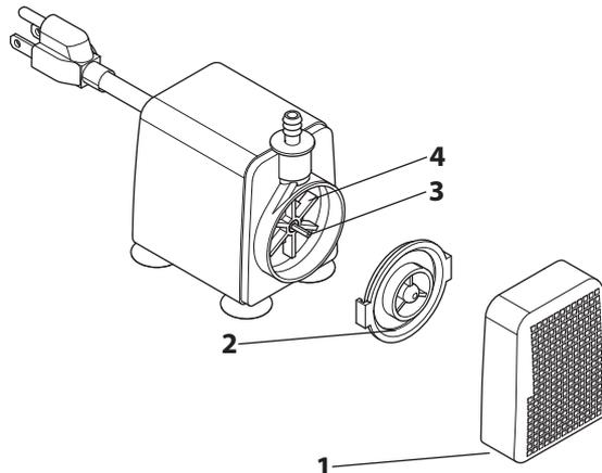
Der kan bruges en klud til at fjerne jernpartikler, der kan sætte sig fast på den magnetiske rotoraksel.
