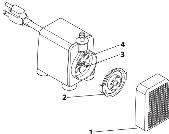
En trasa kan användas för att ta bort järnpartiklar som kan sitta fast på den magnetiska rotoraxeln.
