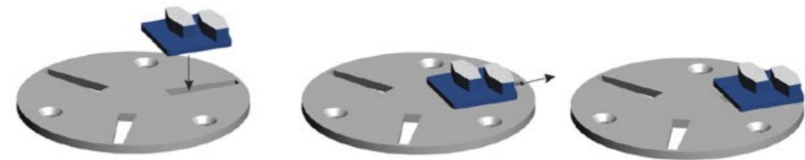
Figur 4-3 Hur man fäster slipsegmenten på Scan-On-fästskivan
