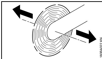
Jos laikkaleikkuria liikutetaan katkaisulaikan pyöriessä nuolen suuntaan, tällöin muodostuu voima, joka pyrkii kallistamaan laitetta.
