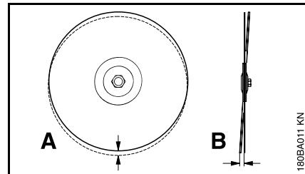
Om rungångsavvikelsen (**A**) är för stor överbelastas vissa diamantsegment som då blir varma. Detta kan leda till sprickor i stambladet eller till att vissa segment börjar glöda.
