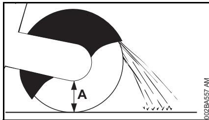
Fremgangsmåten avhenger av den ytre diamteren til røret og den maksimalt mulige snittdybden til kappeskiven (A).
