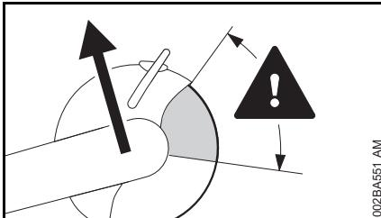
Vid ett kast slungas vinkelslipen plötsligt utan kontroll mot användaren.
