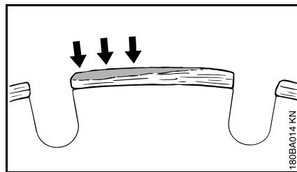
Oppbyggingskutt dannes som lyst grått belegg på oversiden av diamantsegmentene. Dette belegget dekker til diamantene i segmentene og slører segmentene.
