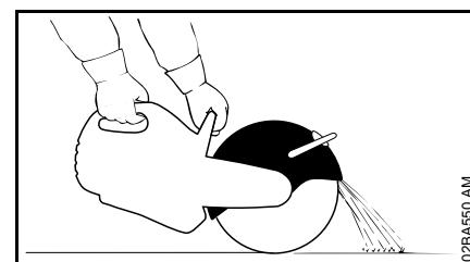
Ställ in skyddet för kapskivan korrekt: För bort materialpartiklar från användaren och maskinen.
