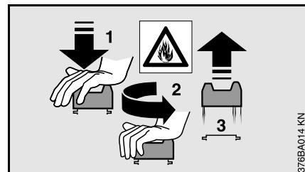
Bajonettanklocket får aldrig öppnas eller stängas med ett verktyg. Locket kan skadas och bränsle kan rinna ut.
