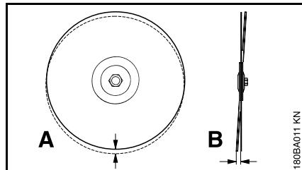
Liian suuren säteisheitton (A) seurauksena yksittäiset timanttilähteet altistuvat liian suurelle kuormitukselle ja ylikuumenevat. Tämä voi johtaa jännityssäröjen muodostumiseen laikan sideaineekseen sekä yksittäisten segmenttien hiiltymiseen.
