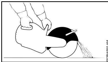
Säädää katkaisulaikan suojuksia oikein: Säädää suojuksien sijat, ettei materiaalihuukkaset ohjautuvat poispäin käyttäjästä ja laitteesta.
