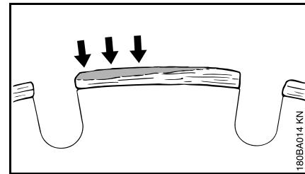
Kanter bildas i form av ljusgrå beläggning på diamantsegmentens översidor. Beläggningen täpper igen diamanterna i segmenten och gör dem slöa.
