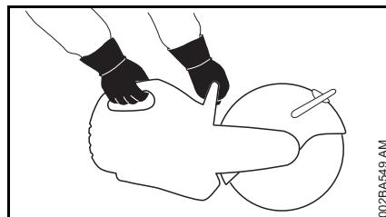
**Håll alltid i maskinen med båda händerna:** Håll i det bakre handtaget med höger hand, gäller även om du är vänsterhänt. Fatta ett säkert tag om handtagsskaftet och handtaget med tummarna.
