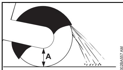
Tillvägagångssättet beror på rörets ytterdiameter och kapskivans (A) största möjliga skärdjup.
