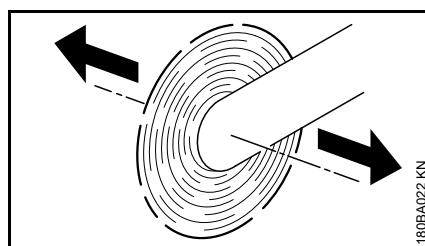
Om vinkelclipen roterar i pilens riktning med en roterande kapskiva, uppstår en kraft som försöker välna maskinen.
