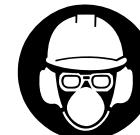
För att minska risken för ögonskador ska tättslutande skyddsglasögon enligt standarden EN 166 användas. Se till att skyddsglasögonen sitter korrekt.
