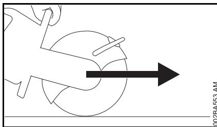
Vinkelsliperen trekkes framover bort fra brukeren når kappeskiven berører gjenstanden som skal kappes ovenfra.
