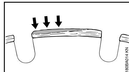
Irtosärmät muodostuvat vaaleanharmaaksi kerrostumaksi timanttilähteiden yläpinnoille. Tämä kerrostuma tarttuu kiinni segmenttien timanttipinnoille ja johtaa segmenttien tylsymiseen.
