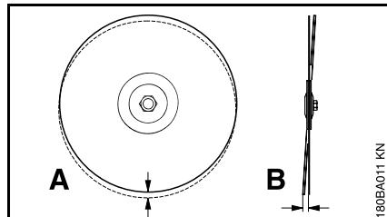
En for stor afvigelse i det runde løb (A) overbelaster enkelte diamantsegmenter, som derved ophedes. Dette kan medføre spændingsrevner i stambladet eller udglødning af enkelte segmenter.
