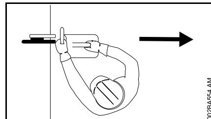
Ha inga kroppsdelar i kapskivans förlängda svängområde. Se till att utrymmet är tillräckligt stort, särskilt i gropar måste det finnas plats för användaren och delen som kapas.
