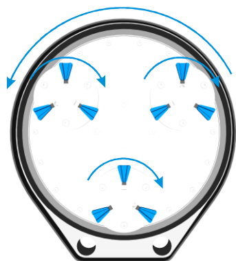
Figur 4-1 Illustrerar hur slipskivorna rör sig i förhållande till sliphuvudet.
